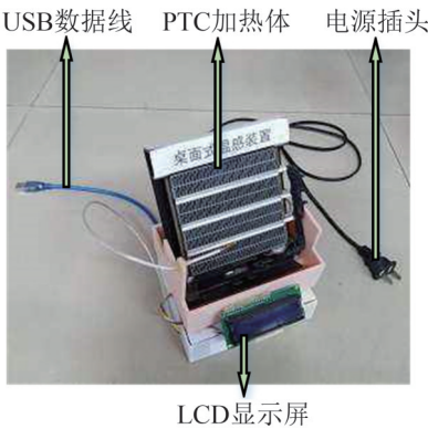
图 3 温感呈现装置 Fig. 3 Temperature sensing device
