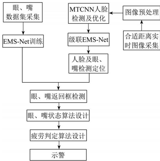
图 11 眼、嘴检测网络流程图
