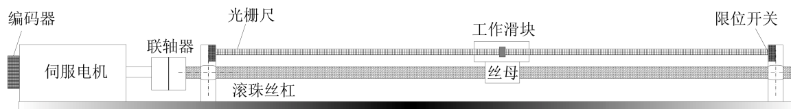
图1 单轴传动结构示意图 Fig. 1 Schematic diagram of single shaft drive structure
