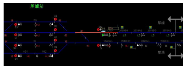
图 11 犀浦站自动发车示意图
