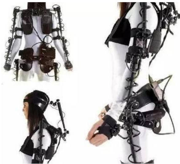
图 9 机械式动作捕捉系统 Fig. 9 Mechanical motion capture system (转载自百度图片)
