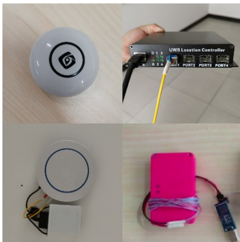
图2 UWB 定位标签、同步控制器、定位基站、自研惯性导航器件
