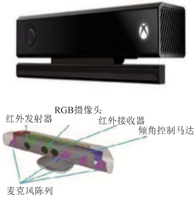
图 2 Kinect 相机结构图 Fig. 2 Structure with Kinect
