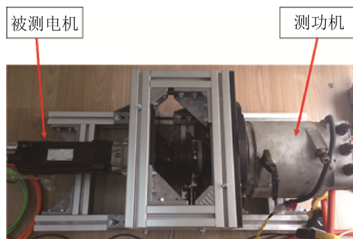
图 14 电机试验平台 Fig. 14 Motor test platform
