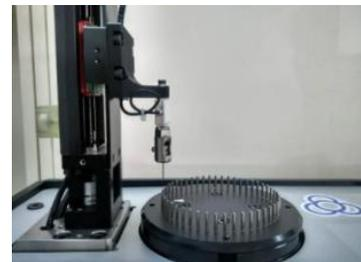
图 9 机械臂拔出插针实验
