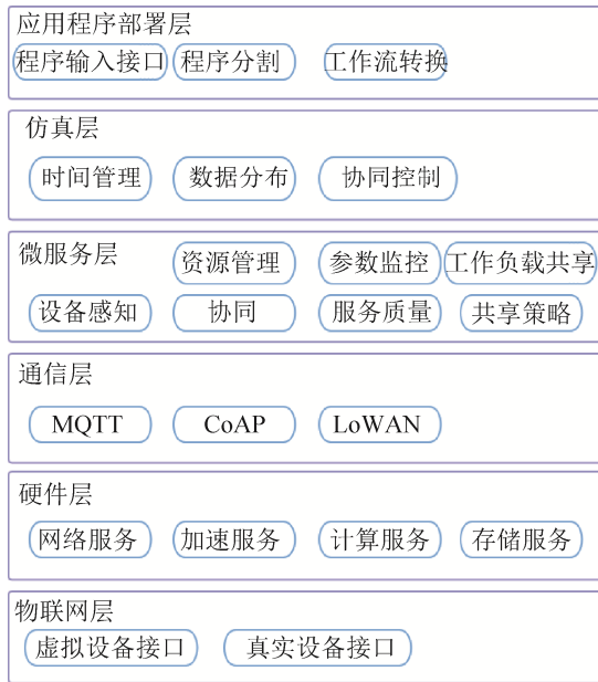
图3 基于微服务的边缘侧仿真框架
