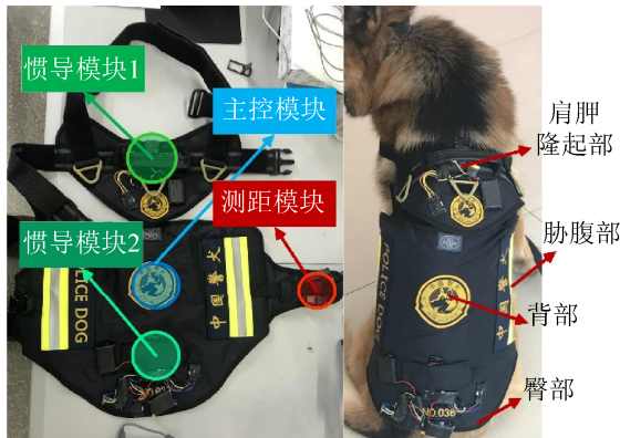
图 4 提出的数据背心及装配示范 Fig. 4 Data vest and assembly demonstration presented
