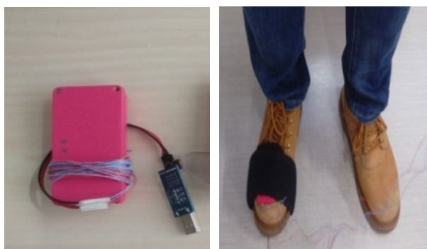
图 3 自研 IMU 模块 Fig. 3 Self-developed IMU module
