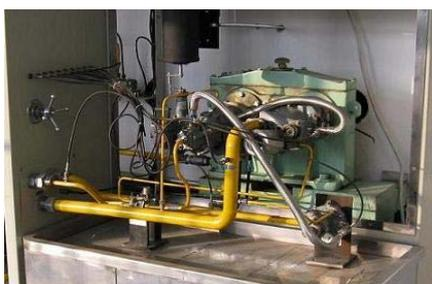
图7 主燃油控制实验系统
