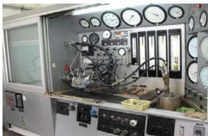
图6 低压转速控制器实验系统
