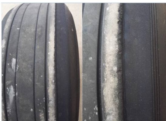
图 7 某航空公司磨损轮胎图 Fig. 7 Diagram of one airline tire wears
