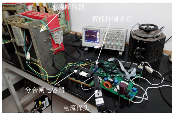
图7 永磁断路器硬件实物实验平台
