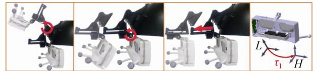
图 6 瞳孔定位设备的机械调整结构
