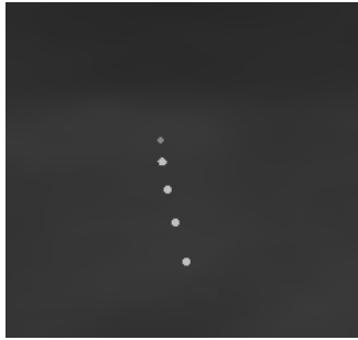
(b) 电阻阵生成的诱饵红外图像
