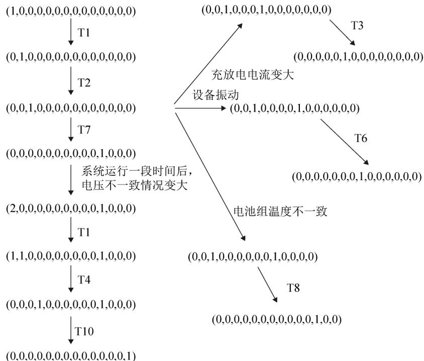
图 5 锂电池故障诊断 Petri 网可达图
