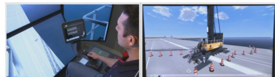
图 2 Vortex 开发的起重机操作训练系统
