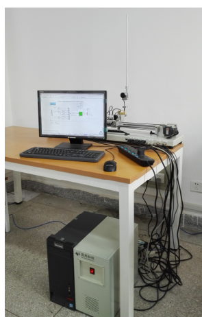
图 6 固高 GLIP2002 直线二级倒立摆系统 Fig.6 GLIP2002 Linear Double Inverted Pendulum
