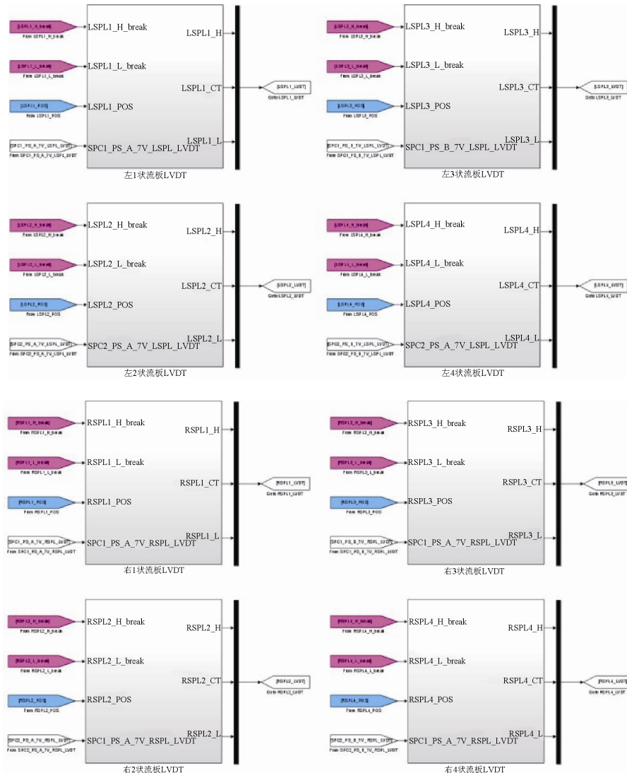
图 12 子系统模型 Simulink 实现-SPC 线位移传感器 Fig. 12 Simulink model for subsystem- SPC LVDT
