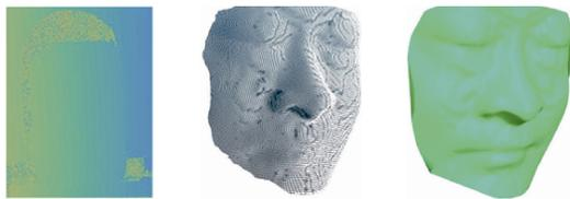
(a) 绝对相位图 (b) 重建点云 (c) 重建面部模型
