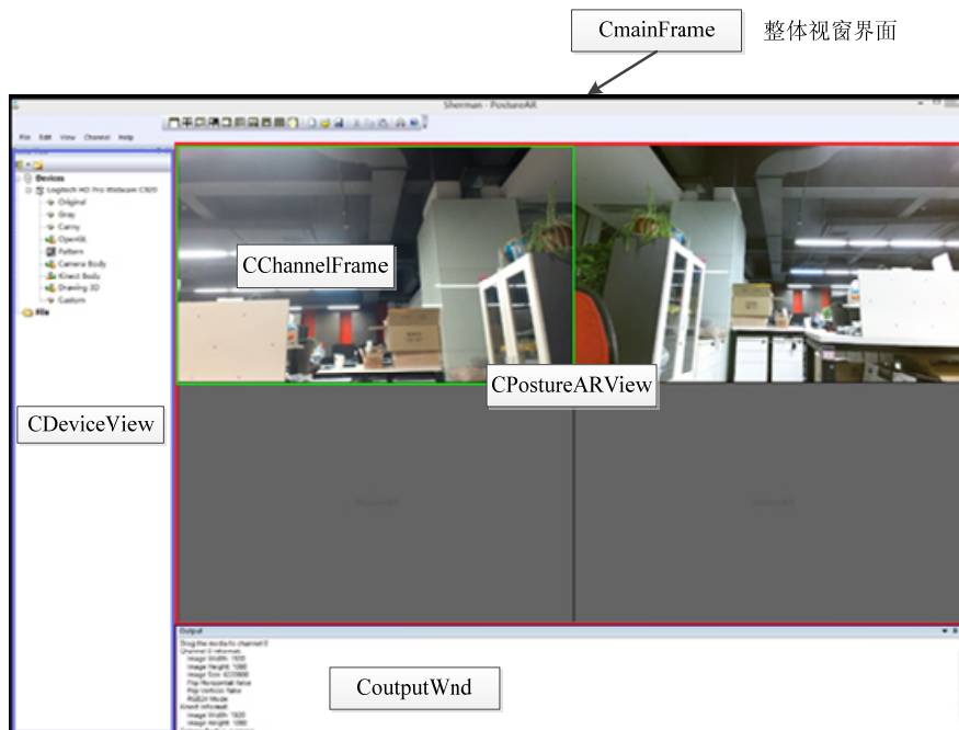
图 5 系统视窗架构 Fig. 5 Windows framework
