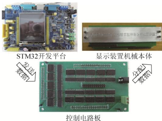
图 6 控制系统的硬件
