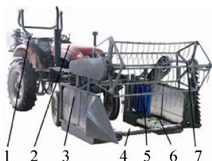
1. 液压驱动系统 2. 东方红-400H 拖拉机 3. PVC 侧板 4. 切割器 5. 纵向输送总成 6. 横向输送带总成 7. 拨禾轮
