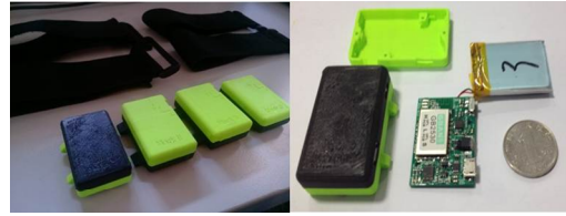
图 2 系统 IMU 节点及其内部结构
