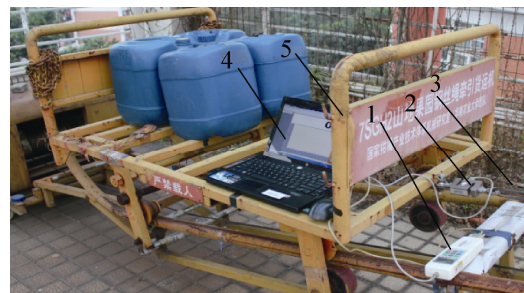
1. 数字显示仪 2. 拉力传感器 3. 钢丝绳 4. 计算机 5. 载物滑车
