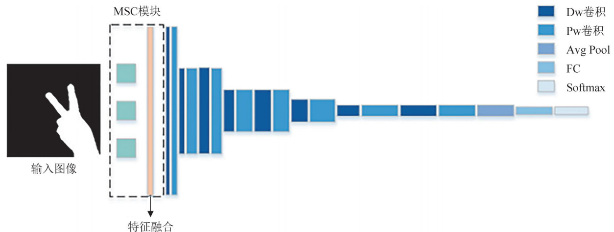
图3 MS-MobileNet 结构图 Fig. 3 MS-MobileNet structure diagram
