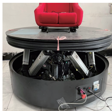
图 14 六自由度运动平台 Fig. 14 Six-freedom motion platform
