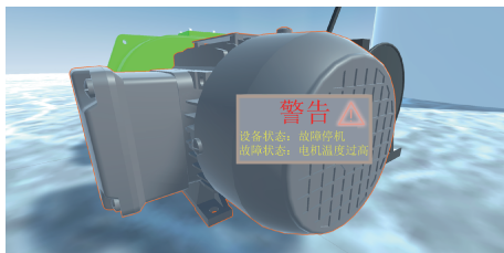
图 12 设备状态故障显示 Fig. 12 Equipment status fault display
